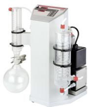
回收泵HBP101的进气接口与旋转蒸发仪连接。工作时只需打开控制面板上的开始键，不需要事先在面板上设定真空值，回收泵HBP101完全能够自动寻找沸点，并进行自动蒸馏，特别适合于沸点未知的溶液和混合溶液。回收泵HBP101的排气端与LVS一样配有冷凝管和回收瓶，能够回收绝大部分的尾气，使真空设备的使用更加清洁，健康和环保。
